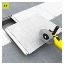
**Blinddeckelabschnitt**Deckelabschnitt L < 500 mm auf die gewünschte Länge zuschneiden.
