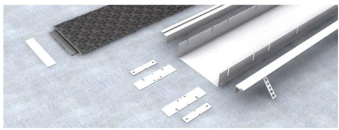
Der estrichbündige Schwerlastkanal besteht aus einem Schwerlastkanalunterteil UBK, drei Schwerlastblinddeckeln UBKD, zwei Seitenprofilen UBKPR sowie Montage- und Verbindungsmaterialien. Diese sind im Lieferumfang als Einzelteile enthalten. Der Kanal ist in den Breiten 200, 300 und 400 mm mit in einer Nivellierhöhe von 100 bis 200 mm einsetzbar und belastbar von 5 bis 25 kN.
