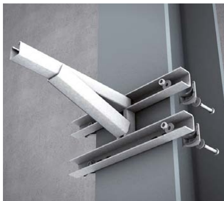
4 | Montage an Stahlträgern mittels schwerer Konsole KISS Die Montage erfolgt mittels vier Trägerklemmen SKS M*.
