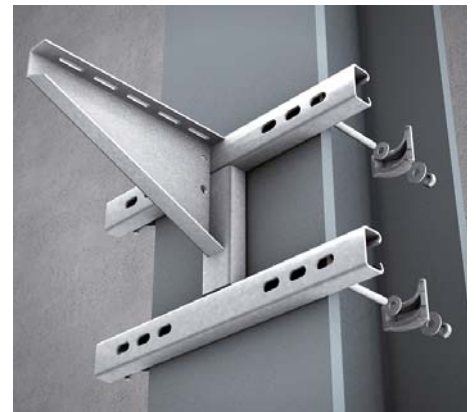
3 | Montage an Stahlträgern mittels schwerer Konsole KIS Die Montage erfolgt mittels vier Trägerklemmen SKS H*.
