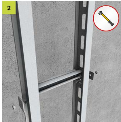
Flachrundschrube (FRS 10X30) und der Rechteckunterlegscheibe (RUS 50-L13) mit der Mutter (SEM 10) verschraubt (Abstand 600 mm).
