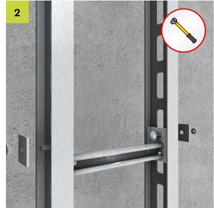
Rechteckunterlegscheibe (RUS 50-L13) mit der Mutter (SEM 10) verschraubt (Abstand 600 mm).
