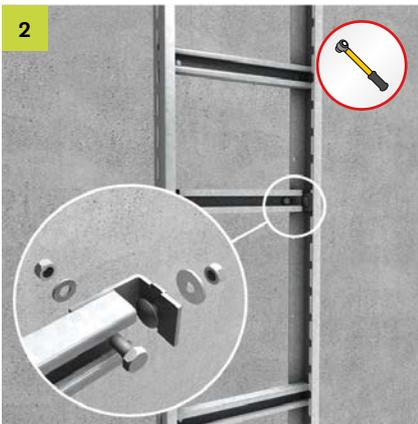
Bei der Steigetrassenvariante mit Nageldübel SNA ist der zusätzliche Einbau mit Sprossen STUS nicht möglich.
