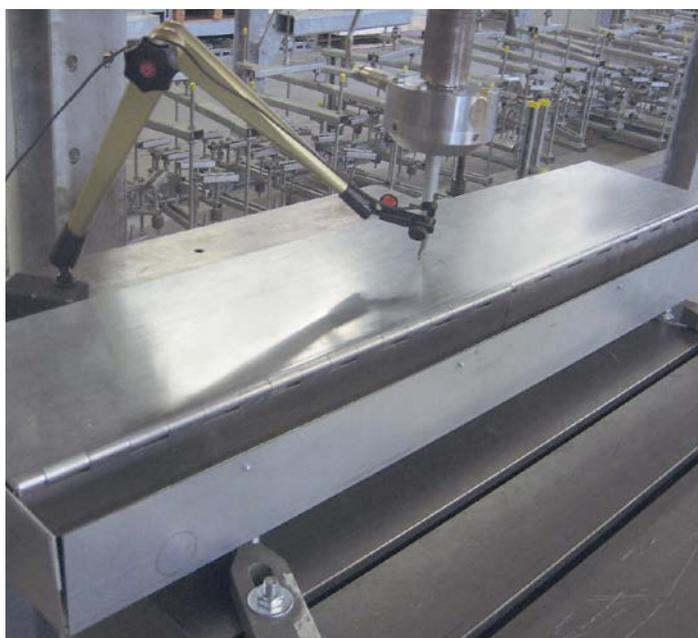
Prüfvorgang mit Prüfkörper Ø 13,3 mm
