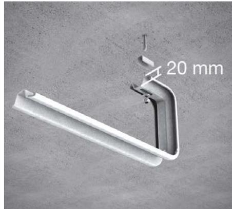
**2 | Deckenmontage mit Deckenbügel DKSL**
