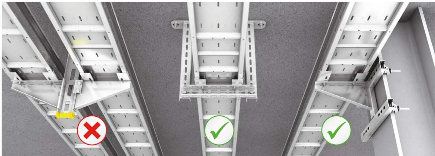
Tragkonstruktionen sind torsionsfrei zu montieren! Die Montage an Hängestielen (ein- oder beidseitig) ist untersagt. Es ist ausschließlich eine Montage an (Wand-) Konsolen oder an Pendelabhängungen zulässig.
