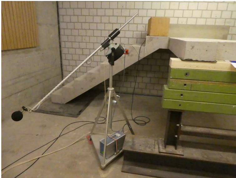
Abbildung 16: vor Ort gegossener Verbund aus Treppenlauf und Podest. Oberhalb des Podests ist die Aussparung zu erkennen, die nach Einsetzen des Podests zubetoniert wurde.
