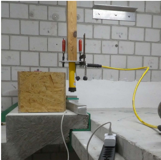
Abbildung 18: Hydraulischer Stempel zum Aufbringen der Zusatzlasten am Treppenlauf.
