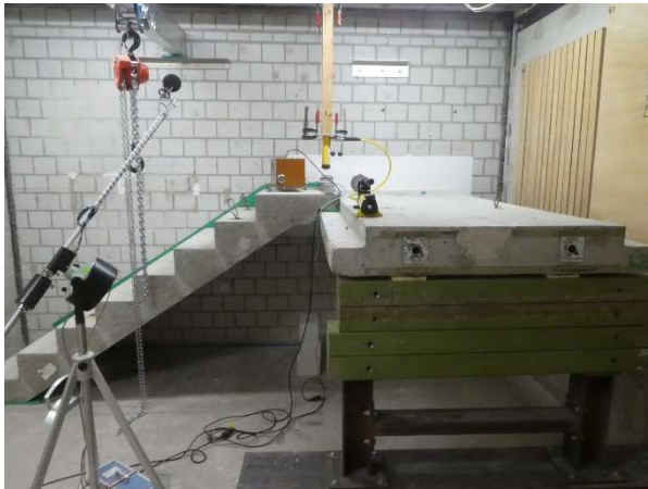
Abbildung 4: Treppenlager, eingebaut zwischen Treppenlauf und Treppenpodest.
