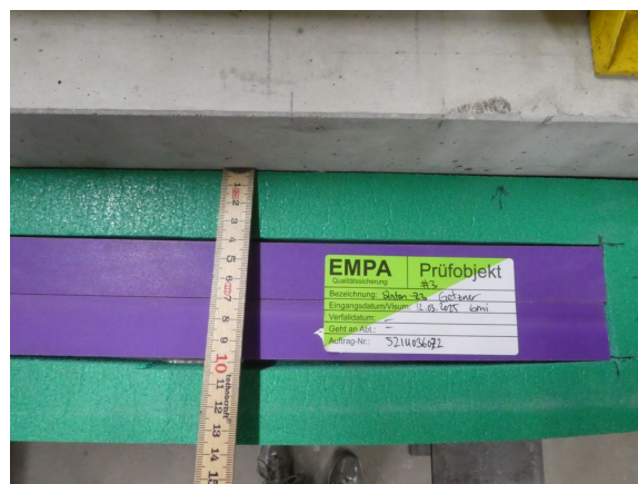
Abbildung 14: Masse des Entkopplungselements Sinton Z-3 für Treppenkopf.
