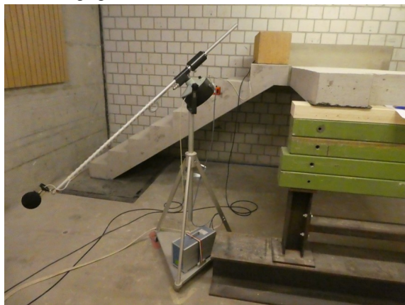
Abbildung 9: Vor Ort gegossener Verbund aus Treppenlauf und Podest.
