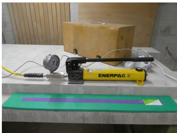
Abbildung 10: Entkopplungselement Sinton Z-1 für Treppenkopf auf Konsole.
