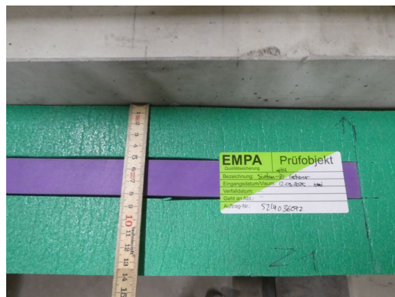
Abbildung 11: Masse des Entkopplungselements Sinton Z-1 für Treppenkopf.
