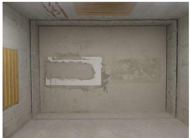
Abbildung 4: Wand mit eingebautem Podestlager, Sicht aus Empfangsraum.
