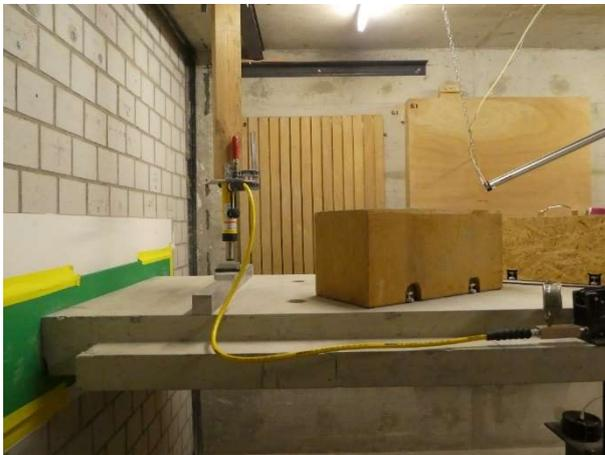
Abbildung 11: Übersicht der Einbausituation und Hammerwerkspositionen auf dem Podest
