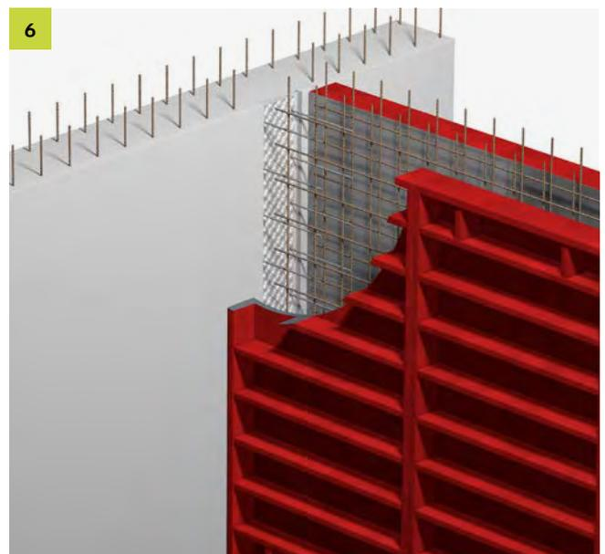
Nach vollständigem Rückbiegen aller Stäbe den zweiten Betonierabschnitt schalen und betonieren.
