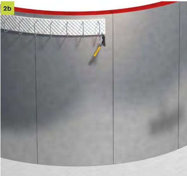
Verwahrkasten vorsichtig in Form biegen und der Schalung anpassen. Befestigung wie bei Schritt 1.
