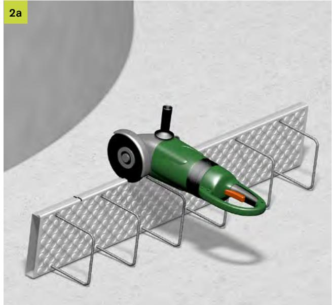
Bei Rundschalung die seitlichen Wangen des Verwahrkastens mit einem Trennschleifer je nach Schalungsradius mehrmals in gleichen Abständen an beiden Seiten anschneiden. Es ist darauf zu achten, die innenliegenden Bewehrungsstäbe nicht zu beschädigen!
