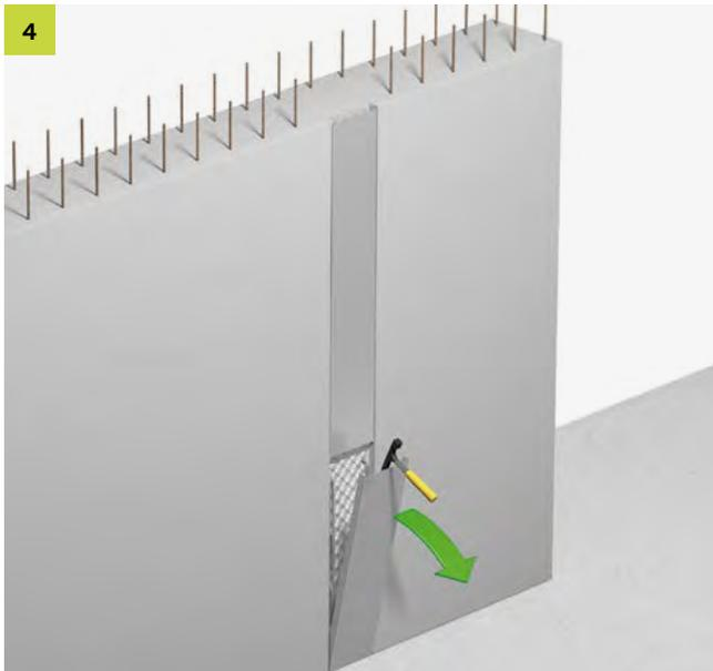
Nach dem ersten Betonierabschnitt die Deckel und die Styroporstopfen an den Enden entfernen.
