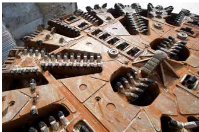
Dzięki nowoczesnym tarczom drążącym TBM możliwe jest drążenie tuneli o średnicy przekraczającej 17,5 m.
