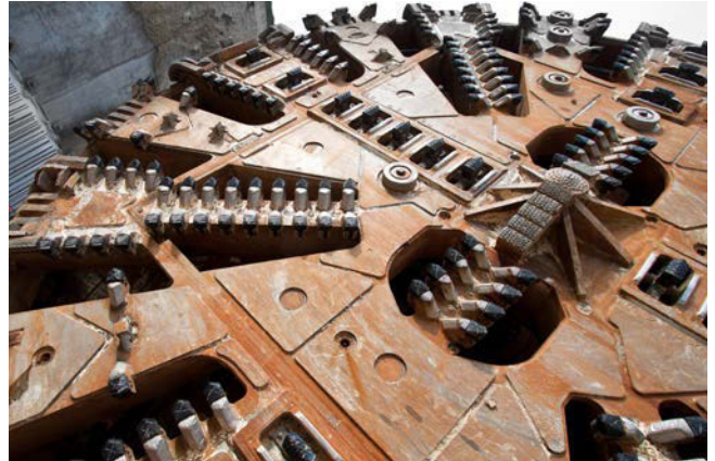
Díky moderním tunelovým razičím strojům lze vyrábět tunelové tubusy o průměru více než 17,5 m.
