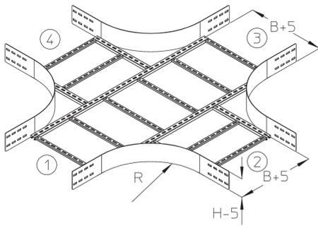
Die Weitspannkabelleiter-Kreuzung WPLK 150 mit integrierten Verbindern dient als Formteil für sich horizontal kreuzende Weitspannkabelleitern. Sie eignet sich für Kabelleitern mit einer Holmhöhe von 150 mm und weist Breiten von 200 bis 600 mm auf. Verschiedene Materialien und Oberflächen sorgen dafür, dass die Korrosionsschutzanforderungen unterschiedlichster Anwendungsgebiete erfüllt werden.
