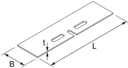
Der Isolierungsstreifen WPHS-IS verhindert die Kontaktkorrosion zwischen der Weitspannholmstütze WPHS und dem Auflager, wenn zwei verschiedenen Metalle zum Einsatz kommen. Er besteht aus EPDM, dient zusätzlich dem Schutz der Oberflächenbeschichtung und ist zur Montageerleichterung einseitig klebend.
