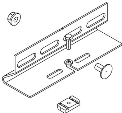
Die Weitspann-Holmstützen WPHS-A dienen der Befestigung von Weitspannkabelleitern oder -rinnen auf C-Profilen. Verschiedene Materialien und Oberflächen sorgen dafür, dass die Korrosionsschutzanforderungen unterschiedlichster Anwendungsgebiete erfüllt werden.
