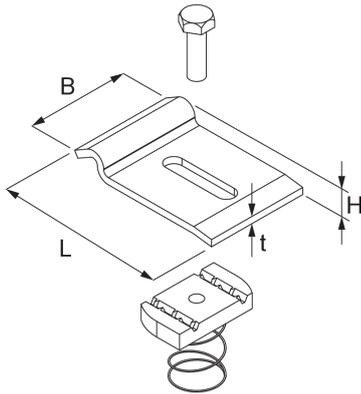
Die Klemmbefestigung WLKLA ist ein Zubehörteil für die Weitspann-Holmstütze WLHS, wenn sie der Lagesicherung einer Weitspanntrasse WL oder WLR 200 auf Profilschienen bzw. Konsolen vom Typ KWSS bzw. KISS dient. Verschiedene Materialien und Oberflächen sorgen dafür, dass die Korrosionsschutzanforderungen unterschiedlichster Anwendungsgebiete erfüllt werden.
