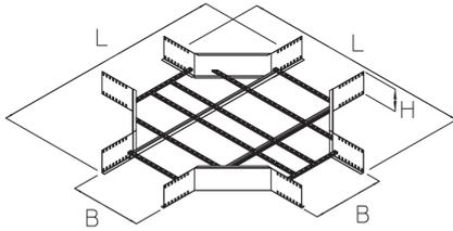
Die Weitspannkabelleiter-Kreuzung WLK 200 mit integrierten Verbindern dient als Formteil für sich horizontal kreuzende Weitspannkabelleitern. Sie eignet sich für Weitspannkabelleitern WL 200 und weist Breiten von 237 bis 637 mm an der jeweiligen Kabelleiteranschlussstelle auf. Sie besteht aus tauchfeuerverzinktem Stahl.
