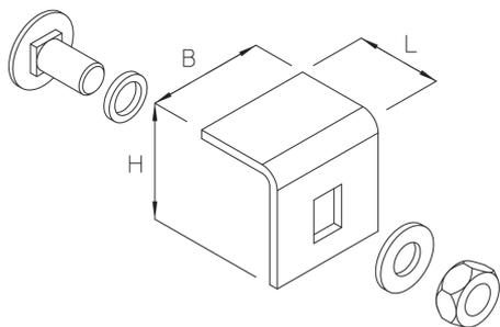
Der Sturmsicherungswinkel WLD-SW dient der zusätzlichen Sicherung der Weitspann-Deckel bei Verwendung im Außenbereich. Es sind mindestens 6 Sicherungselemente pro 3 Meter Kabelbahn-Deckel gemäß der Montageanleitung zu verwenden. Bei windexponierten Bereichen muss die Anzahl der Deckelklammern auf mindestens 10 Stück erhöht werden. Der Sturmsicherungswinkel wird von außen auf den Weitspann-Deckel aufgesetzt und verschraubt. Er besteht aus tauchfeuerverzinktem Stahl.
