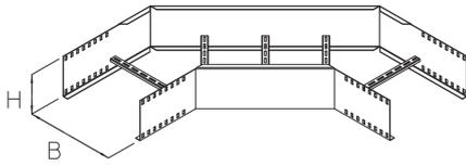
Die Weitspannkabelleiter-Bögen WLB 200 mit integrierten Verbindern ermöglichen horizontale Richtungsänderungen der Kabelführung um 90°. Sie eignen sich für Weitspannkabelleitern WL 200 und weisen Breiten von 200 bis 600 mm auf. Der Bogen wird in die Weitspannkabelleiter eingeschoben und verschraubt. Anschließend wird die Anschlussleiter am Bogen montiert. Sie bestehen aus tauchfeuerverzinktem Stahl.
