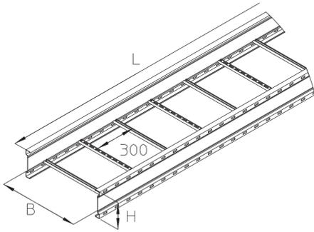
Die Weitspannkabelleitern WL 200 haben eine Holmhöhe von 202 mm und eine Bahnbreite von 200 bis 600 mm. Sie sind in einer Standardlänge von 6000 mm erhältlich. Die Sprossen bestehen aus gelochten Profilschienen. Die Weitspann-Holmstützen sind zur Befestigung auf der Unterkonstruktion zu verwenden. Verschiedene Materialien und Oberflächen sorgen dafür, dass die Korrosionsschutzanforderungen unterschiedlichster Anwendungsgebiete erfüllt werden.
