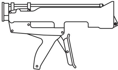
Das Auspressgerät VA-AP für 2-Kammer-Kartuschen dient dem schnellen und ermüdungsfreien Ausdrücken des Verbundankermörtels VAB-HB M. Die Herstellerangaben sind zwingend einzuhalten.
