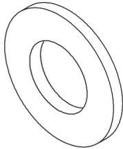
Die Unverlierbarkeitsscheibe UVS erleichtert die Vormontage von Schrauben. Die UVS wird auf das Schraubengewinde aufgeschoben und verklemt sich am Schraubengewinde. Die Schraube ist somit vormontiert und unverlierbar. Die UVS besteht aus Polyamid und ist für die Gewindegrößen M6, M8 und M10 verfügbar.
