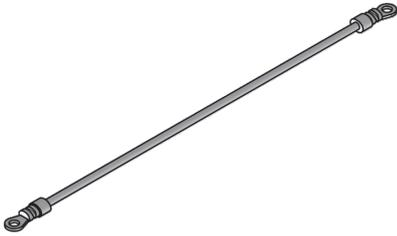
Bei den Bauelementen UVA GB1 handelt es sich um Erdungsleitungen - ein Hilfsmittel aus dem Sortiment der Einbaueinheiten aus Edelstahl. Die Leitungen sorgen, zum Beispiel als Teil des Erdungslaschensets UEBSEL, für einen zuverlässigen Erdungs- und Potentialausgleich. Die Zubehörteile müssen beidseitig verschraubt werden. Sie sind aus hochwertigem Kupfer gefertigt.
