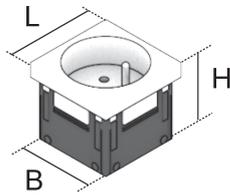
Bei den Bauelementen UST45FR 1 handelt es sich um einteilige, 1-fache Einbausteckdosen mit Erdungsstift in einer Ausführung von 45x45 mm. Sie lassen sich mithilfe von Steckklemmen in die passenden UAM-Abdeckplatten einsetzen. Die Steckdosen werden aus hochwertigem Polycarbonat gefertigt und sind in verschiedenen Farben erhältlich. Die 2-poligen Schutzsteckdosen besitzen einen erhöhten Berührungsschutz und sind für eine Nennspannung/-Stromleistung von AC 250 V, 10/16 A geeignet.
