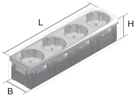
Bei den Bauelementen UST45 4 handelt es sich um einteilige, 4-fache Schutzsteckdosen in einer Ausführung von 45x45 mm. Sie lassen sich mithilfe von Steckklemmen in die passenden UAM-Abdeckplatten einsetzen. Die Steckdosen werden aus hochwertigem Polycarbonat gefertigt und sind in verschiedenen Farben erhältlich. Die Schutzsteckdosen besitzen einen erhöhten Berührungsschutz und sind für eine Nennspannung/- Stromleistung von AC 250 V, 10/16 A geeignet.
