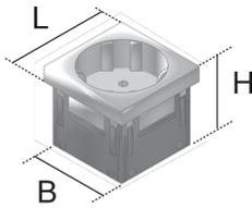
Bei den Bauelementen UST45 1 handelt es sich um einteilige, 1-fache Schutzsteckdosen in einer Ausführung von 45x45 mm. Sie lassen sich mithilfe von Steckklammern in die passenden UAM-Abdeckplatten einsetzen. Die Steckdosen werden aus hochwertigem Polycarbonat gefertigt und sind in verschiedenen Farben erhältlich. Die Schutzsteckdosen besitzen einen erhöhten Berührungsschutz und sind für eine Nennspannung/- Stromleistung von AC 250 V, 10/16 A geeignet.
