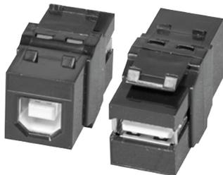
Bei den Bauelementen UKM-USB2AB handelt es sich um Keystone Einbauadapter zur Bestückung von Unterflursystemen. Die Adapter besitzen zwei USB 2.0-Verbindungsbuchsen Typ AB und lassen sich in Datenaufnahmeeinheiten mit einer 19,5x14,7 mm großen Einbauöffnung einrasten. Ihre schwarzen Gehäuse sind aus hochwertigem Polycarbonat gefertigt.
