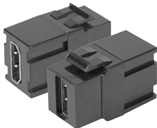
Bei den Bauelementen UKM-HDMI handelt es sich um Keystone Einbauadapter zur Bestückung von Unterflursystemen. Die Adapter besitzen zwei HDMI-Verbindungsbuchsen Typ A und lassen sich in Datenaufnahmeeinheiten mit einer 19,5x14,7 mm großen Einbauöffnung einrasten. Ihre schwarzen Gehäuse sind aus hochwertigem Polycarbonat gefertigt.
