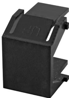
Bei den Bauelementen UKM-B handelt es sich um Keystone Blindeinsätze zur Bestückung der Unterflureinheiten. Sie dienen dort als Abdeckung ungenutzter Ports. Die Einsätze lassen sich in Datenaufnahmeeinheiten mit einer 19,5x14,7 mm großen Einbauöffnung einrasten. Ihr schwarzes Gehäuse ist aus hochwertigem Polycarbonat gefertigt.
