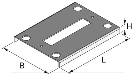
Beim Bauteil UKENPS handelt es sich um eine Schwerlastplatte aus dem Produktsortiment der Unterflursysteme. Sie wird zwischen der Nivellierplatte UKENP und dem Kompakteinzelauslass platziert. Dank der Platte kann die Konstruktion eine Last von bis zu 20 kN abtragen. Die Schwerlastplatte ist aus sendzimir-feuerverzinktem Stahlblech nach DIN EN 10346 gefertigt.
