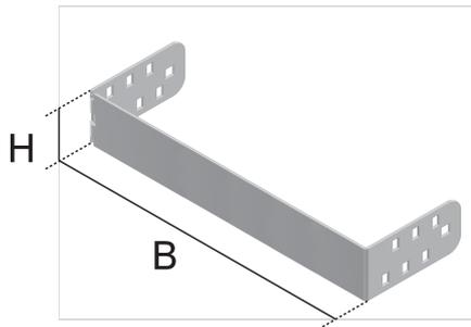
Bei der Produktlösung UKEB handelt es sich um Endbleche, die zum Verschließen estrichüberdeckter Kabelkanäle verwendet werden. Die Bauelemente der Unterflursysteme sind aus sendzimir-feuerverzinktem Stahlblech nach DIN EN 10346 angefertigt. Sie sind in einer Breite von 300 bis 500 mm erhältlich. Bei einer Höhe von 20 bis 45 mm werden sie inklusive eines Klemmbefestigungssets KLR und ab einer Höhe von 70 mm inklusive zweier Sets geliefert.
