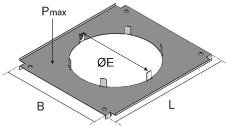
Bei der Produktlösung UKDA 308R handelt es sich um Kabelkanal Montagedeckel mit runden Einbauöffnungen für offene, estrichüberdeckte Kanalsysteme. Sie dienen als Zug- und Einbaudosen, die in ihre Einbauöffnung einen Schalungskörper aufnehmen. Die Montagedeckel sind aus sendzimir-feuerverzinktem Stahlblech nach DIN EN 10346 gefertigt. Sie sind, inklusive Erdungsklemme UBDHB-Z, in einer Breite von 300 bis 500 mm und einer maximalen Belastungshöhe von 0,75 kN erhältlich.
