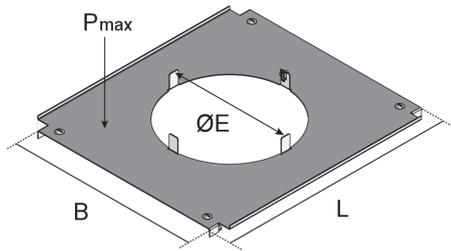
Bei der Produktlösung UKDA 260R handelt es sich um Kabelkanal Montagedeckel mit runden Einbauöffnungen für offene, estrichüberdeckte Kanalsysteme. Sie dienen als Zug- und Einbaudosen, die in ihre Einbauöffnung einen Schalungskörper aufnehmen. Die Montagedeckel sind aus sendzimir-feuerverzinktem Stahlblech nach DIN EN 10346 gefertigt. Sie sind, inklusive Erdungsklemme UBDHB-Z, in einer Breite von 300 bis 500 mm und einer maximalen Belastungshöhe von 0,75 kN erhältlich.
