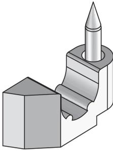
Die Zugentlastungen UGZ-R sind mechanische Schutzvorrichtungen, die sich in runde Gerätebecher aus dem Portfolio der Unterflurssysteme einsetzen lassen. Dort werden sie mithilfe der Blechschrauben BLS befestigt und schützen die elektrischen Leitungen vor unerwünschtem Herausreißen.
