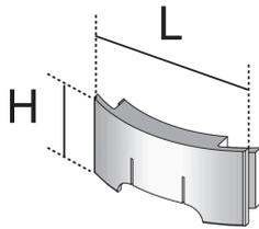
Bei den Bauelementen UGM handelt es sich um Gummimuffen aus dem Portfolio der Einbaueinheiten für Unterflursysteme. Diese Zubehörteile sorgen für einen staubdichten Verschluss des Kabelauslasses in den Einzelauslässen BODO N/NL. Die Muffen werden aus hochwertigem Kunststoff TPE Shore 70 gefertigt, der sich durch sein thermoplastisches Verhalten und besonders hohe Elastizität auszeichnet. Die UGM besitzen eine VDE/TÜV-Zulassung gemäß DIN EN 50085.
