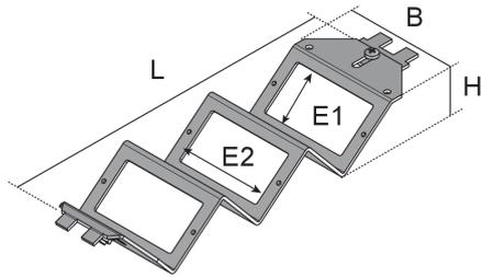
Bei den Bauelementen UGETD handelt es sich um Datengeräteträger aus dem Portfolio der Unterflursysteme. Die Geräteträger lassen sich passgenau in Einbaueinheiten einrasten. Anschließend können sie mit bis zu drei UDEP-Einbauplatten für Daten-, Audio- und Videotechnik bestückt werden. Die Datengeräteträger sind aus sendzimir-feuerverzinktem Stahlblech, nach DIN EN 10346, in der Farbe Schwarz (ähnlich RAL 9011) gefertigt und mit einem Einbaumaß E1 von 33.5 mm und E2 von 59.5 mm erhältlich.
