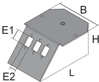
Bei den Bauelementen UGET 3 SCS handelt es sich um Gerätebechereinbauträger aus dem Portfolio der Unterflursysteme. Die Einbauträger werden in die Gerätebecher UG geschraubt und dienen zur Aufnahme von maximal 3 Lichtwellen-Datenjacks des Typs SC-Somplex oder SC-Duplex. Sie sind aus sendzimir-feuerverzinktem Stahlblech, nach DIN EN 10346, in der Farbe Schwarz (ähnlich RAL 9011) gefertigt und mit einem Einbaumaß E1 von 13.5 mm und E2 von 9.6 mm erhältlich.
