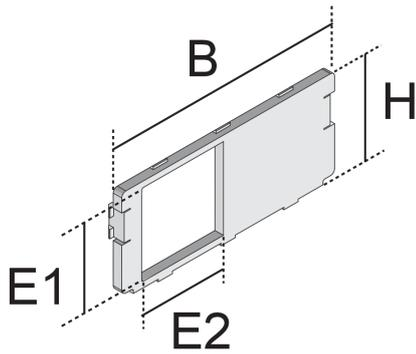
Bei den Bauelementen UGEE 1 UST S handelt es sich um Geräteblenden für Starkstromtechnik. Sie werden frontal in einen Geräteeinsatz eingerastet und dienen dort zur Aufnahme von einer einfachen Schutzkontaktsteckdose 0° mit dem Maß 45 x 45 mm. Die Blenden sind aus hochwertigem Polyamid in der Farbe Schwarz (ähnlich RAL 9011) gefertigt.
