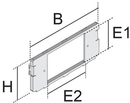
Bei den Bauelementen UGEE 1 DEP S handelt es sich um Geräteblenden aus dem Sortiment der Geräteeinsätze für Datentechnik. Sie werden bei der Montage in den Geräteeinsatz gegenüber der Starkstromtechnik frontal und bündig zum Boden des Einsatzes eingerastet und können dort mit einer Einbauplatine UDEP bestückt werden. Die Blenden sind aus hochwertigem Polyamid in der Farbe Schwarz (ähnlich RAL 9011) gefertigt.
