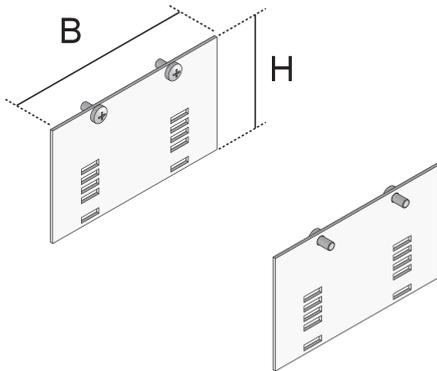
Bei den Bauelementen UGEAV1-2 handelt es sich um eckige Rastleitersets. Die Rastleiter werden als Einbaurahmen in Einzelauslässe montiert und dienen dort der Aufnahme von bis zu zwei Platinen UGET1-2, UG-R bzw. UGR 1-4. Die UGEAV1-2 sind aus sendzimir-feuerverzinktem Stahlblech, nach DIN EN 10346, gefertigt. Die Rastleitersets können mit einem Rastbereich von 25 mm erworben werden.
