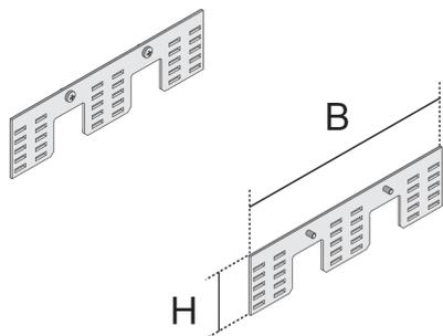
Bei den Bauelementen UGEAV handelt es sich um Rastleitersets für eckige Edelstahleinheiten. Die Rastleitern lassen sich an die Rahmen der Niveleereinheiten UNE für viereckige Edelstahlkassetten mit Kabel- bzw. Tubauslass schrauben. Die Kassetten können anschließend mit bis zu drei Gerätebechern für Installationsgeräte bestückt werden. Die Rastleitersets sind aus sendzimir-feuerverzinktem Stahl (DIN EN 10346) gefertigt.
