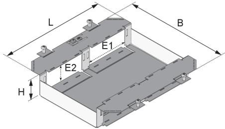
Bei den Bauelementen UGE3 VRK handelt es sich um Geräteeinsätze mit seitlichen Blenden, die in Einbaueinheiten aus Kunststoff geschraubt werden können. Die Einsätze lassen sich mit maximal vier Installationsgeräten der Größe 45x45 mm und 6 Dateneinzeljacks bestücken. Sie sind aus sendzimir-feuerverzinktem Stahlblech gefertigt.
