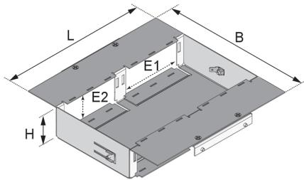
Bei den Bauelementen UGE3 VE handelt es sich um Geräteeinsätze mit seitlichen Blenden, die in viereckige Einbaueinheiten aus Edelstahl, geeignet für bis zu drei Gerätebecher, geschraubt werden können. Die Einsätze lassen sich mit bis zu vier Installationsgeräten der Größe 45x45 mm und bis zu 6 Dateneinzeljacks bestücken. Sie sind aus sendzimir-feuerverzinktem Stahlblech, nach DIN EN 10346, gefertigt.
