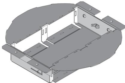
Bei den Bauelementen UGE3 RDDE handelt es sich um Geräteeinsätze mit seitlichen Blenden, die in runde Einbaueinheiten aus Edelstahl, geeignet für maximal drei Gerätebecher, geschraubt werden können. Die Einsätze lassen sich mit bis zu vier Installationsgeräten der Größe 45x45 mm und bis zu 6 Dateneinzeljacks bestücken. Sie sind aus sendzimir-feuerverzinktem Stahlblech, nach DIN EN 10346, gefertigt.
