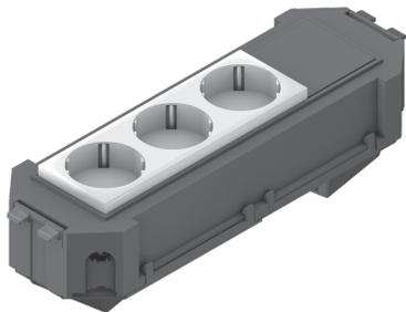
Bei den Bauelementen UG45WI-3 handelt es sich um vorkonfektionierte Gerätebecher. Sie sind mit einem 3-poligen Snap-In-Gerätestecker des Herstellers Wieland, einer vorverdrahteten Steckdose (3-fach) und allen Abdeckungen und Montagematerialien ausgestattet. Die Gerätebecher können im Bodenbereich mit 3-poligen Anschlussleitungen mit Stecker und Buchse verbunden werden. Sie sind aus Acrylnitril-Butadien-Styrol-Copolymerisat gefertigt.
