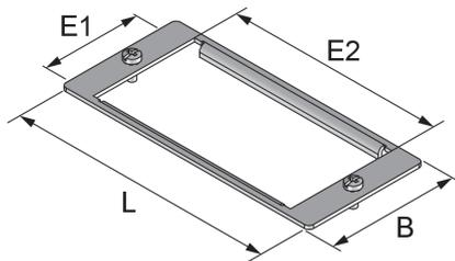
Bei den Bauelementen UEP160 UST handelt es sich um Einbauplatten aus dem Produktsortiment der Unterflursysteme. Diese Zubehörteile werden in Kompakteinzelauslässe geschraubt und dort zur Aufnahme von bis zu zwei Installationsgeräten mit den Maßen 45x45 mm verwendet. Die Platten sind aus sendzimir-feuerverzinktem Stahlblech nach DIN EN 10346 gefertigt.
