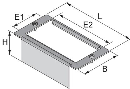
Bei den Bauelementen UEP160 UST-TR handelt es sich um Einbauplatten aus dem Produktsortiment der Unterflursysteme. Diese Zubehörteile werden in Kompakteinzelauslässe geschraubt und dort zur Aufnahme von bis zu zwei Installationsgeräten mit den Maßen 45x45 mm verwendet. Die Platten sind aus sendzimir-feuerverzinktem Stahlblech nach DIN EN 10346 gefertigt.
