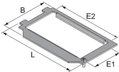
Bei den Bauelementen UEP125 UST handelt es sich um Einbauplatten aus dem Produktsortiment der Unterflursysteme. Diese Zubehörteile werden in Kompakteinzelauslässe geschraubt und dort zur Aufnahme von bis zu zwei Installationsgeräten mit den Maßen 45x45 mm verwendet. Die Platten sind aus sendzimir-feuerverzinktem Stahlblech nach DIN EN 10346 gefertigt.
