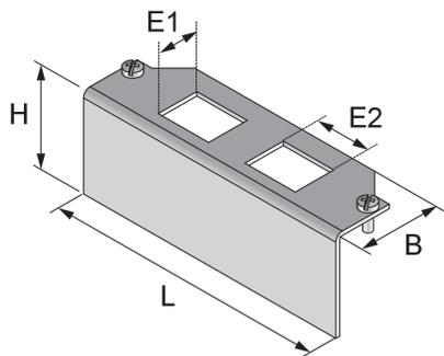
Bei den Bauelementen UEP125 KS handelt es sich um Einbauplatten aus dem Produktsortiment der Unterflursysteme. Diese Zubehörteile können mit zwei angeschlossenen Keystone-Datenjacks bestückt und anschließend seitlich mit dem Rahmen eines Kompakteinzelauslasses verschraubt werden. Die Platten sind aus sendzimir-feuerverzinktem Stahlblech nach DIN EN 10346 gefertigt.
