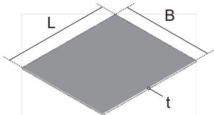
Bei den Produktlösungen UEKD V handelt es sich um Zubehör aus dem Portfolio der Unterflursysteme. Diese eckigen Deckeinlagen werden in viereckige Kunststoffklappdeckel eingesetzt, um dort Bodenaussparungen zu verringern. Die Zubehörelemente werden aus hochwertigem Karton gefertigt und besitzen eine Breite von 169 mm und eine Länge von 210 mm. Sie sind in einer Materialstärke von 3 mm erhältlich.
